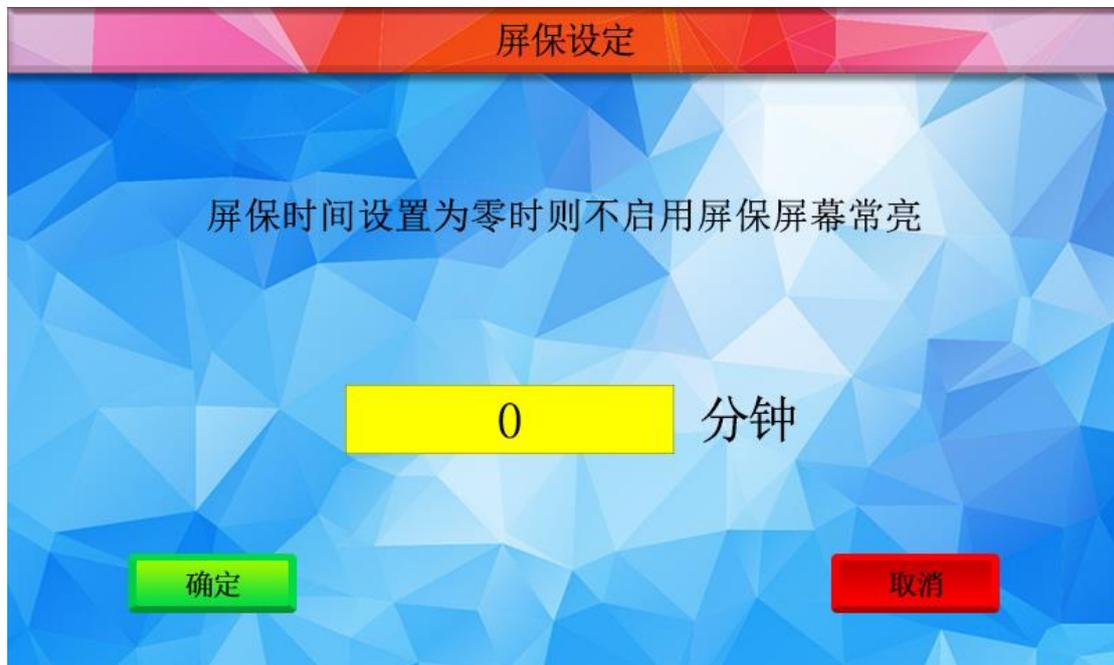
2、 屏幕待机延时：输入框内输入数字即屏幕待机几分钟后关闭屏幕显示，延长屏幕使用时间。屏幕关闭后，不影响控制器正常自动运行。如要恢复屏幕显示，碰触屏幕即可显示屏幕内容。设置 0，即屏幕不会进入屏幕保护。
