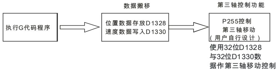
因此使用 Z 轴移动控制时，请避免重复使用到 D1328~D1331、P255 等装置。
