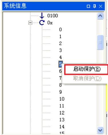
b. 按鼠标右键确认，5 变成 5\_ ( P ) 表示 Ox5 已设定为加密保护
