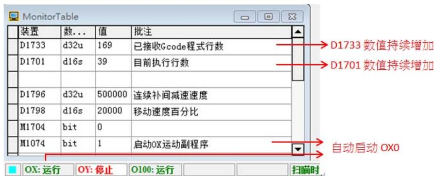
**Step 6**：程序运作中若没有要停止，则忽略此步骤。若程序要停止不要继续运作，只要点选 PMGD L 软件中的「取消」按钮（如下图所示），而程序执行的行数等于下载行数时，就停止运作 G 代码程序。若要重新下载运作程序，需先停止 O100 程序后，再启动 O100 程序。
