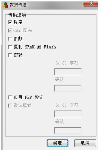
b. 开始下载程序 (DVP-PM 主机无设定密码保护程序区，无论程序有无内含 CAM 数据)
