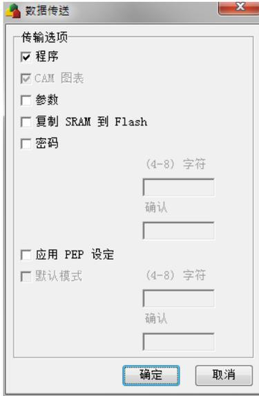
b. 开始下载程序 (DVP-PM 主机有设定密码保护程序区，无 CAM 数据下载)
