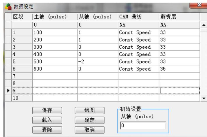
在设定里位置 1~3 的设定跟之前相同，但在位置 4 改成了 600，同时在位置 500 时反转的速度设定为 2 倍，如主轴以 100kHz 运行时可节省  $700 - 600 = 100$  pulses，即约 1ms 的时间。要注意的是如果位置 1 跟位置 4 要相同（即回到同一点），在速度规划上正的面积要跟负的面积相同。
