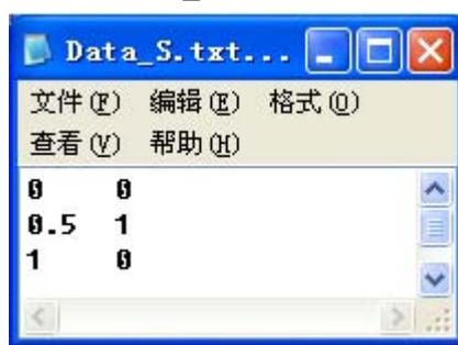
Data\_S.txt 内容设定 SlaveMax=1、MasterMax=1，这样的电子凸轮来做为绕线机的最小单位，之后可以利用 D1816 之 Bit1/Bit0 设定电子凸轮运行于机械单位，再依绕线输入的条件决定电子凸轮放大多少倍率；用户也可直接设定电子凸轮运行于电机单位，接着再用 DTO 动态修改 SlaveMax/MasterMax。在知道输入条件后，需要换算出的设定有 1. 绕线（主/Y）轴一段速的距离、2. SlaveMax/MasterMax，接下来说明在输入条件下如何求得这些设定。
