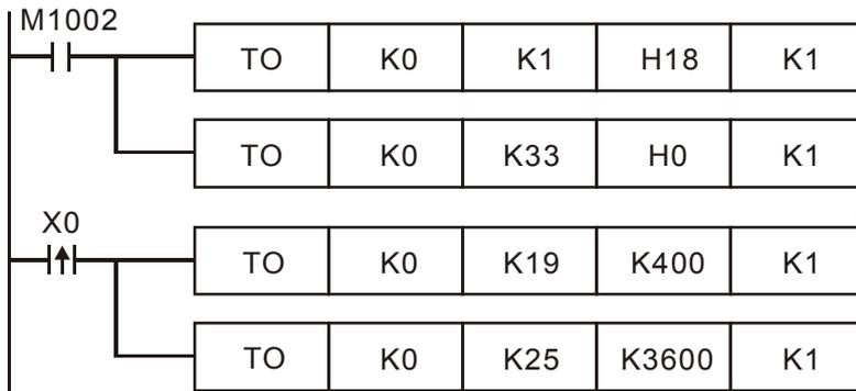
1. 对模拟信号输入模块编号 0 之 CR#1 写入 H18，CH2 设为模式 3 (电流输入-20mA~+20mA)。
