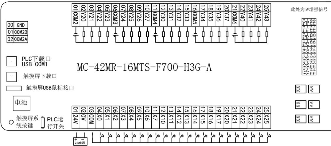
输入属于NPN型，不需要外接电源，直接短接COM和X点即可。
