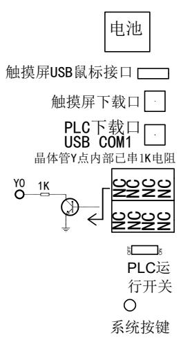
输入属于NPN型，不需要外接电源，直接短接COM和X点即可。
