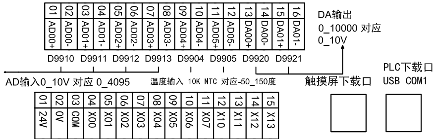
4.3寸一体机MM_20MR_6MT_430A_ES_B接线图
