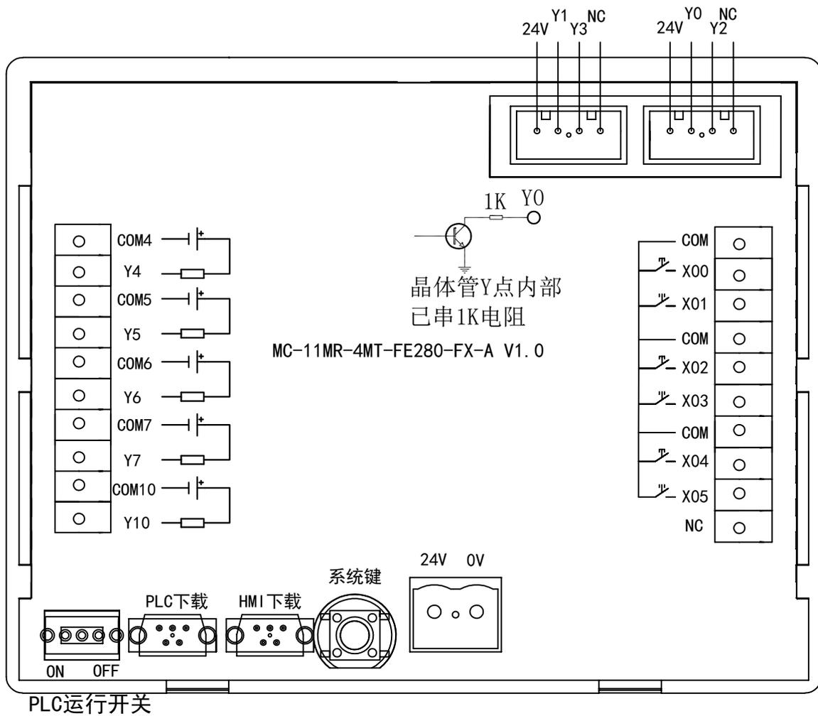
输入属于NPN型，无需要外接电源，直接短接COM和X点即可
