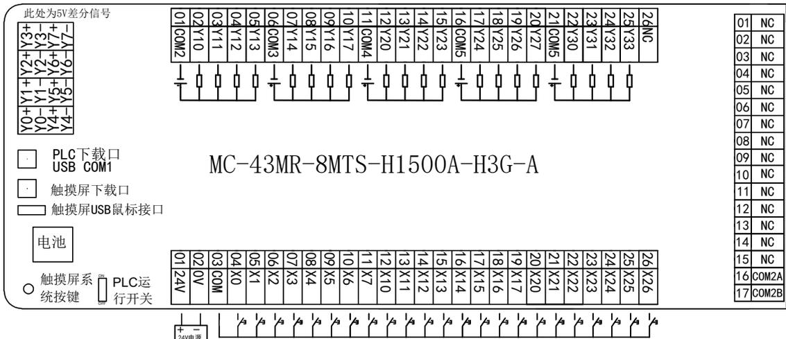
输入属于NPN型，不需要外接电源，直接短接COM和X点即可。
