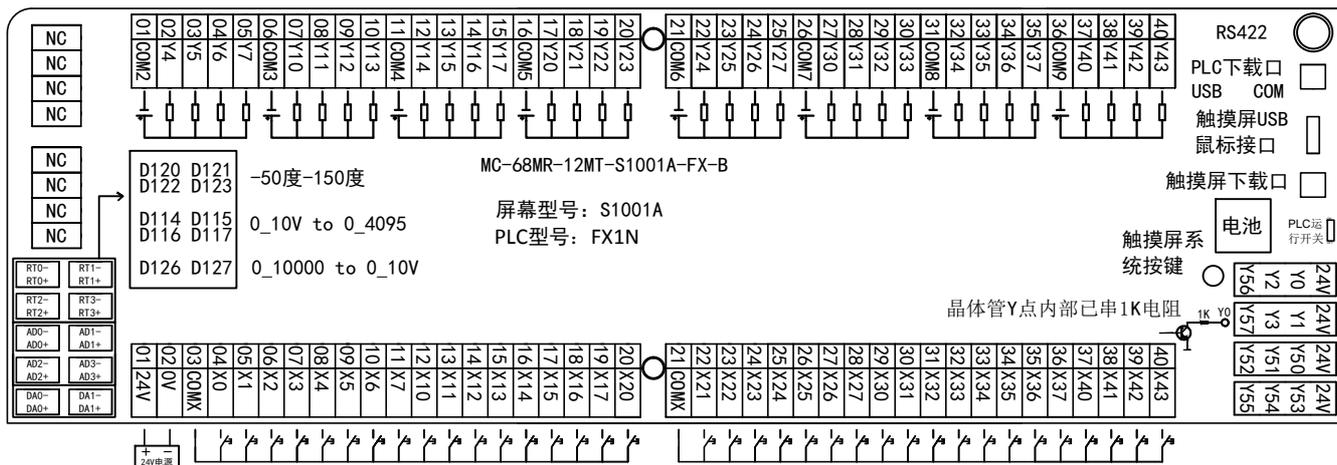
输入属于NPN型，不需要外接电源，直接短接COM和X点即可
