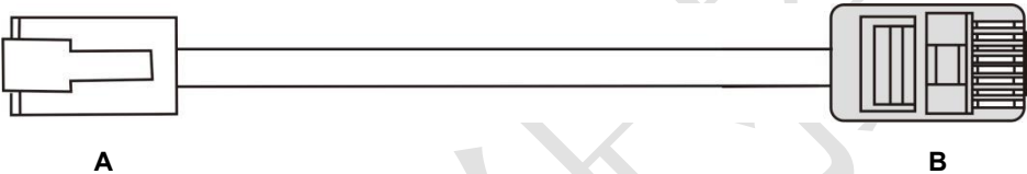
图4.10 伺服驱动器多机并联线缆示意图
