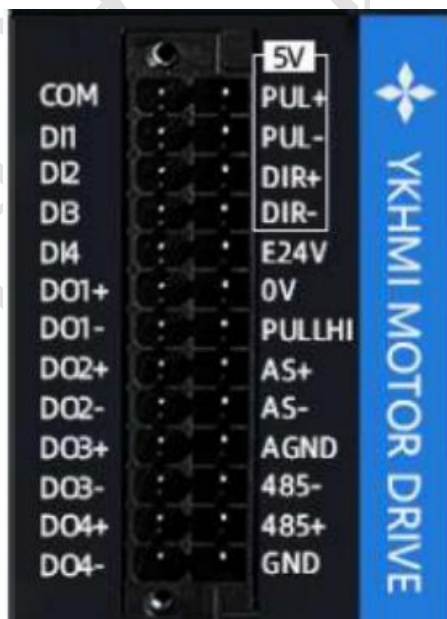
图 4.5 驱动器 CN1 端子引脚示意图
